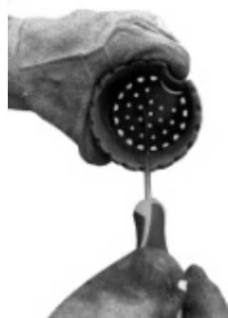
Fig. 32 - het schoonmaken van de vuurpot
